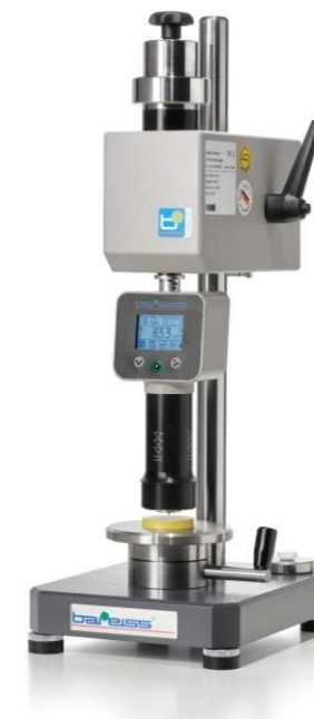
Тестовая стойка BSA Автоматическая тестовая стойка со скоростью опускания 3,2 мм/с в соотв. со стандартами
