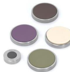
Тестовые блоки для внутризаводской поверки DIN EN ISO 48
